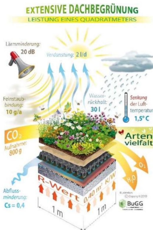
Abb. 1: Leistungsfähigkeit eines Quadratmeters extensiver Dachbegrünung © BuGG
